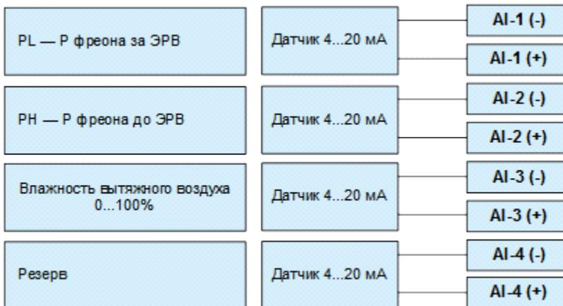
При использовании двухкомпрессорной схемы на 3-й и 4-й датчик подключаются датчики давления второго компрессора; датчик влажности подключается на тот же 3-й канал второго контроллера.
